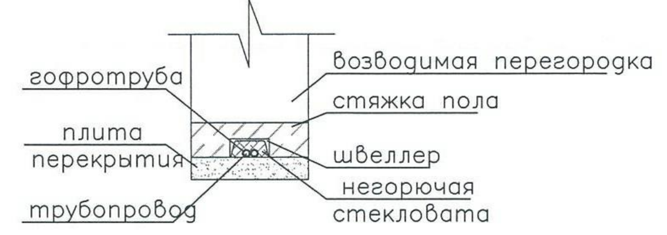
Схема прохождения трубопроводов через ограждающие конструкции
